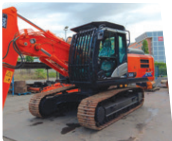
Protezioni cabina (superiore e frontale)
