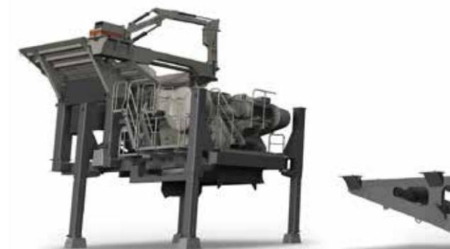
Il dispositivo "easy split" rende le operazioni di trasporto molto semplici ed è consigliata nel caso in cui il cliente abbia l'esigenza di spostare la macchina con frequenza. Per mettere la macchina sul mezzo di trasporto non è necessario l'uso di apparecchi di sollevamento e passare dalla configurazione di trasporto a quella operativa è questione di poche ore.
