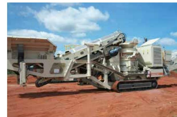
Il Lokotrack LT300HP è disponibile con alimentatore a nastro o in alternativa con alimentatore sgrassatore vibrante.
