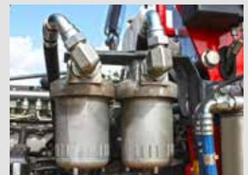
Come optional, offriamo la sostituzione in remoto del filtro della trasmissione. In questo modo la sostituzione sarà veloce e pulita.
