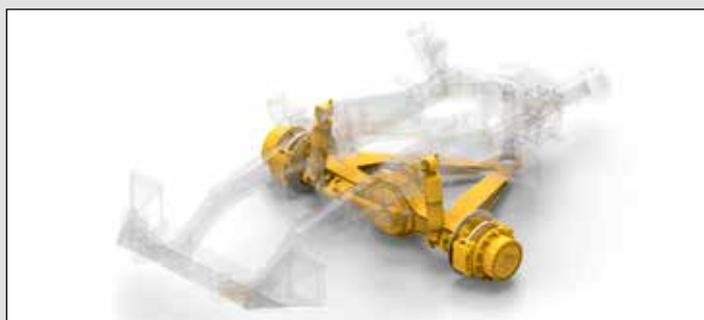
Coniugando produttività e confort il sistema di sospensioni montato sul telaio a forma di A aganciato a barre di sospensione idropneumatiche riduce la vibrazione laterale che spesso si avverte in condizioni di fuori strada. Il sedile dotato anch'esso di sospensioni rinforzate fornisce un ulteriore isolamento all'operatore.
