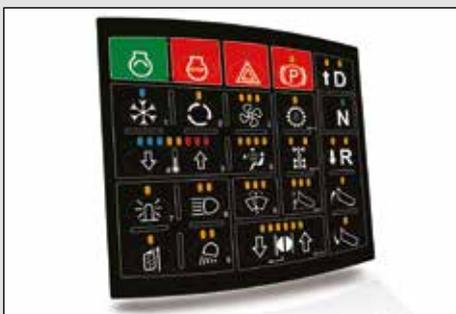
Il pratico pannello strumenti permette di controllare in modo semplice e immediato le numerose funzioni di potenziamento della produttività tra le quali: **Accensione senza chiavi, Inclinazione, Limite superiore di ribaltamento del Cassone, Selezione della funzione Arresto Lento/Arresto brusco, Potenza del retarder e Controllo della Velocità.**
