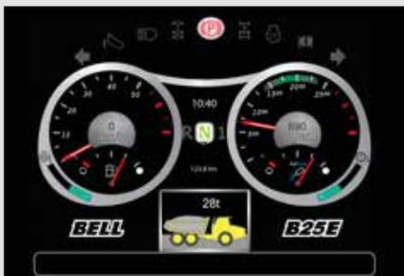
L'esclusivo sistema di pesatura a bordo consente all'operatore di visualizzare in tempo reale le informazioni sul carico utile mentre la macchina viene caricata. È possibile azionare la modalità "riduzione della velocità" in presenza di sovraccarico.
