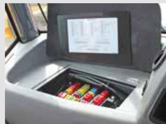
Un ripartitore di carico all'interno della cabina facilita la sostituzione dei fusibili. Il numero ridotto di relé, connettori e cablaggi si traduce in una maggiore affidabilità.
