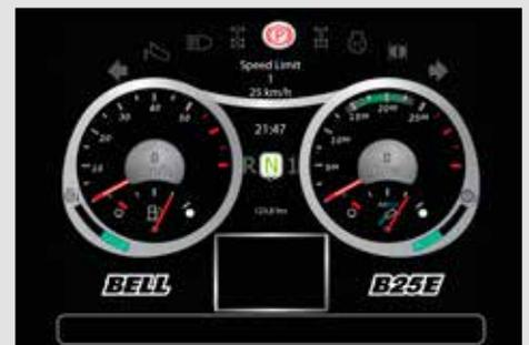
Il controllo della velocità massima, che può essere selezionata o dall'operatore o direttamente in cantiere, fa in modo che il veicolo riduca automaticamente la velocità ed entri in azione il retarder per evitare l'eccesso di velocità all'interno del cantiere.
