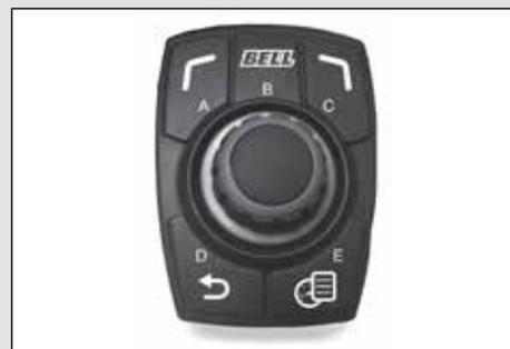
Un dispositivo di controllo automotive visualizza il menu di navigazione sul monitor a colori con le informazioni sul funzionamento e le regolazioni di messa a punto della macchina.
