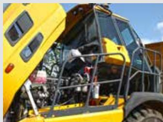
La cabina può essere inclinata in pochi minuti senza che siano necessari attrezzi particolari, per poter effettuare facilmente qualsiasi intervento di manutenzione degli organi di trasmissione.
