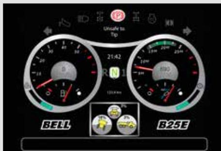
Il sensore di beccheggio e rollio impedisce al cassone di aprirsi se la posizione del dumper non è sicura.
