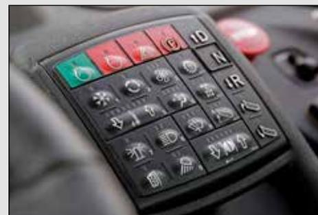
Messa in moto senza chiavi, identità del conducente e codici di accesso impediscono a persone non autorizzate di utilizzare la macchina.
