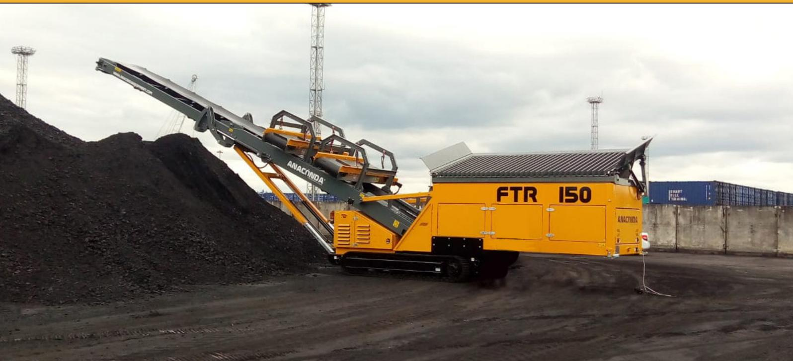
La serie Anaconda **FTR** di alimentatori mobili su cingoli è progettata per il settore di movimentazione del materiale e mira a ridurre il tempo di movimentazione e a risparmiare sui costi di impilaggio.
