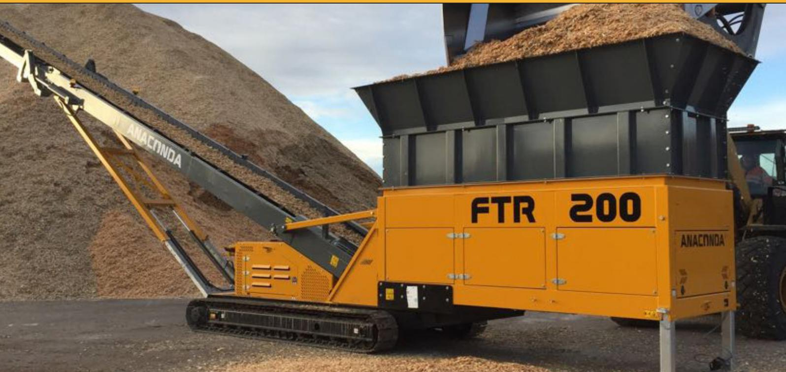
La serie Anaconda **FTR** di alimentatori mobili su cingoli è progettata per il settore di movimentazione del materiale e mira a ridurre il tempo di movimentazione e a risparmiare sui costi di impilaggio.
