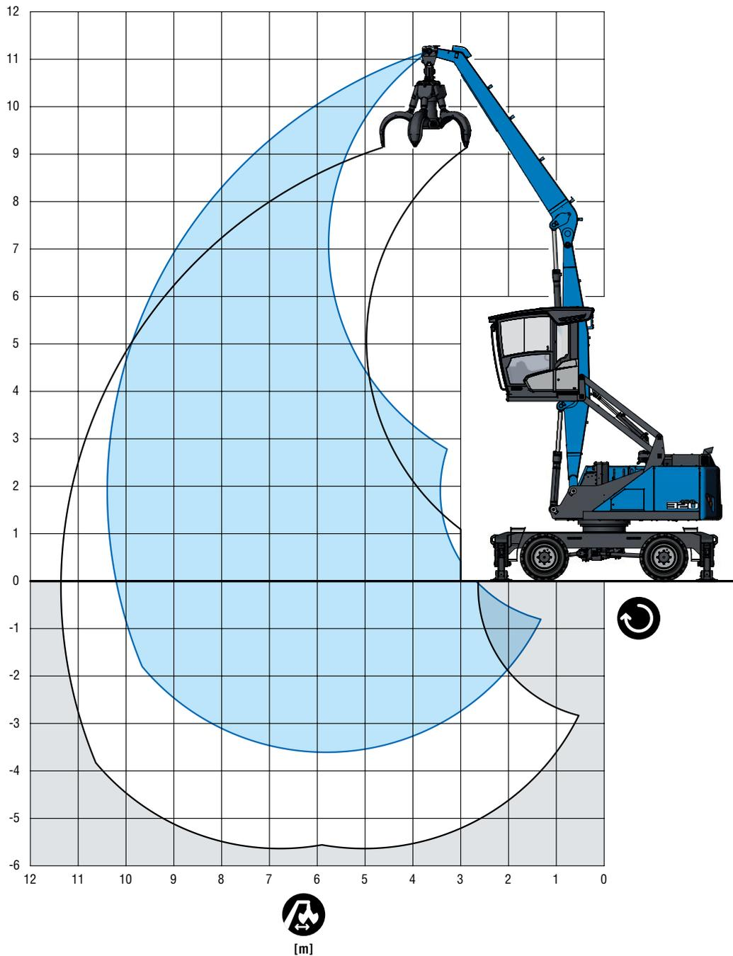
Lifting capacity | Traglast | Capacité de charge | Capacidad de carga | Capacità di carico | Capacidade de carga
