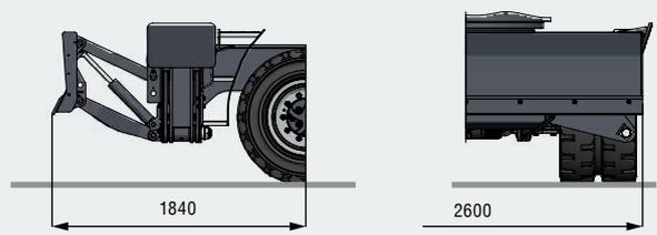
**2-point Stabilizers and support blade | 2-Punkt-Abstützung und Stützschild | 2 stabilisateurs et lame d'appui
