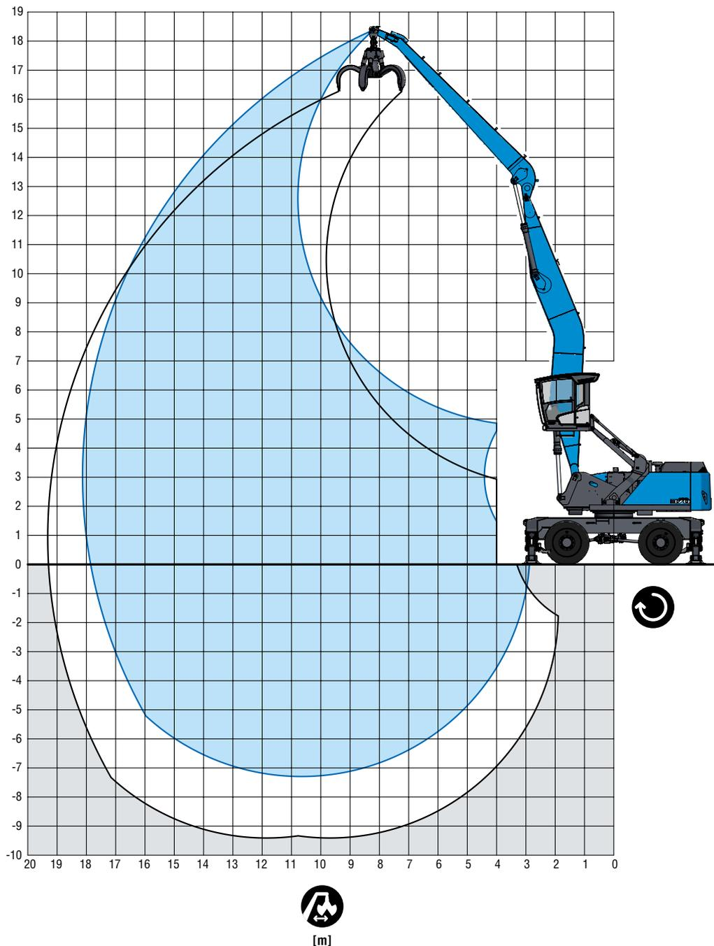
Lifting capacity | Traglast | Capacité de charge | Capacidad de carga | Capacità di carico | Capacidade de carga
