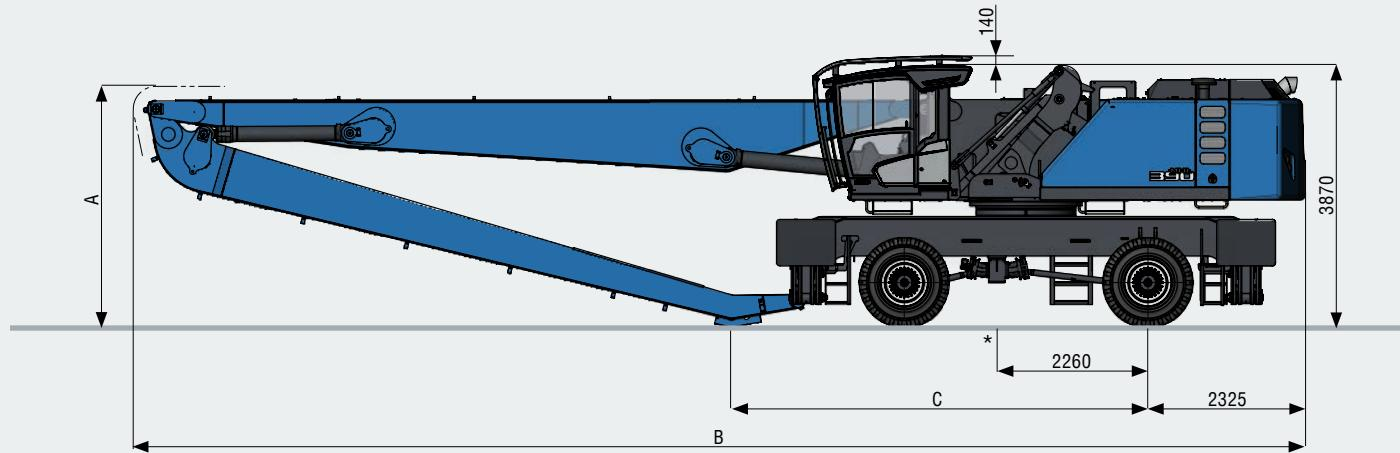
**Work equipment Banana Boom | Arbeitsausrüstung gekrüppelter Ausleger | Équipement de travail flèche coudée**
