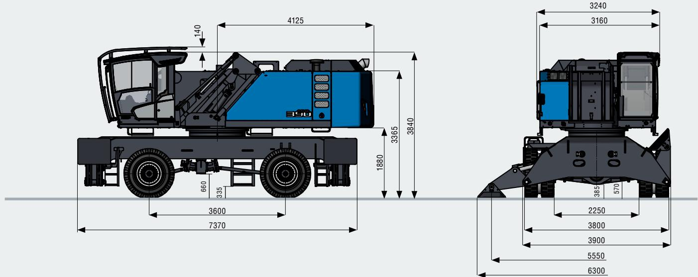
With "Port" cab riser | Mit Kabinenhubsystem „Port“ | Avec système de levage de cabine « Port » | Con sistema de elevación de cabina «Port» | Con sistema di sollevamento cabina “Port” | Com sistema de elevação de cabine “Port”
