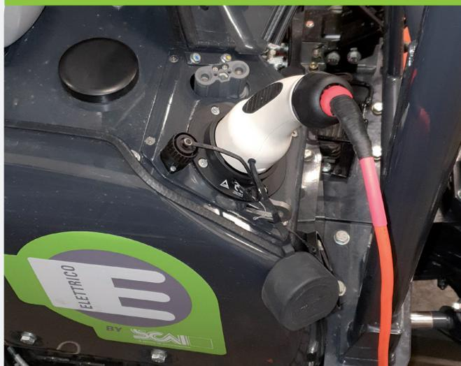
Connessione da caricatore rapido che necessita a sua volta di alimentazione 380V AC trifase
