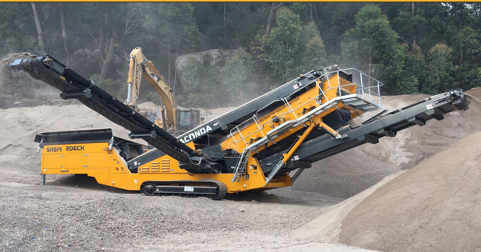
**La serie di vagli di finitura mobili su cingoli Anaconda SR è stata sviluppata appositamente per applicazioni in cui la separazione dei materiali fini è cruciale.**
