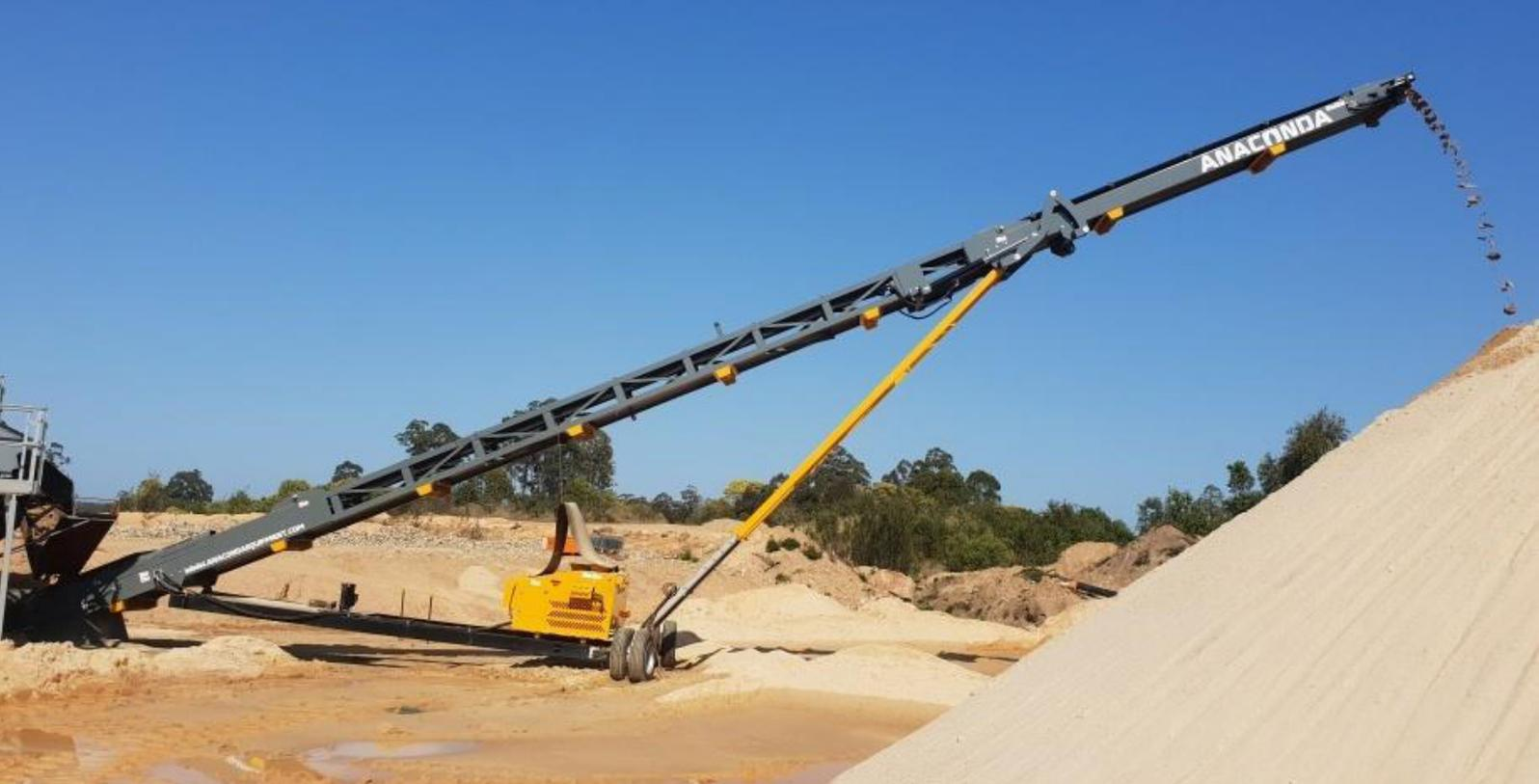
**La serie Anaconda **ST** di trasportatori mobili su ruote è progettata per il settore di movimentazione del materiale e mira a ridurre il tempo di produzione e a risparmiare sui costi di impilaggio.**
