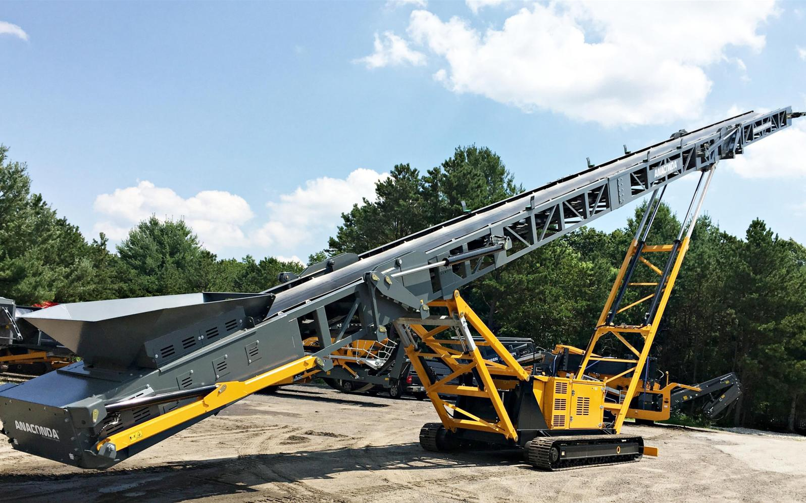
La serie Anaconda **TR** di trasportatori mobili su cingoli è progettata per il settore di movimentazione del materiale e mira a ridurre il tempo di produzione e a risparmiare sui costi di impilaggio.
