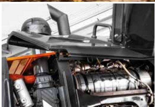
Il sistema SCR riduce le emissioni dello scarico.
