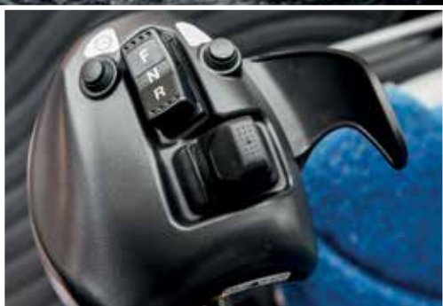
Il joystick di sterzo- optional permette un controllo eccezionale.
