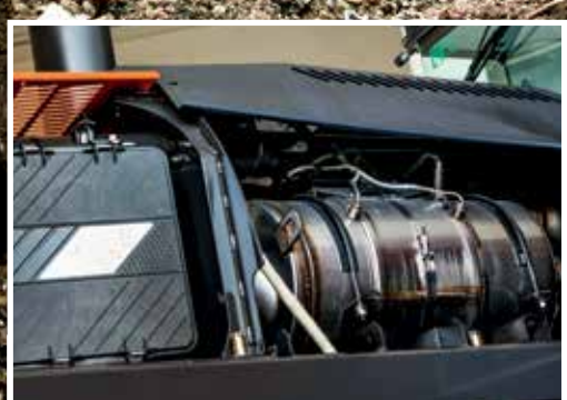
Il sistema SCR riduce le emissioni e i livelli sonori.
