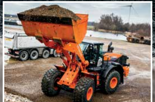
Il sistema di controllo del flusso assicura la fluidità del movimento del braccio di sollevamento.
