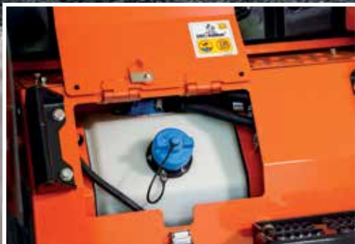
L'urea viene iniettata nel gas di scarico per ridurre le emissioni.
