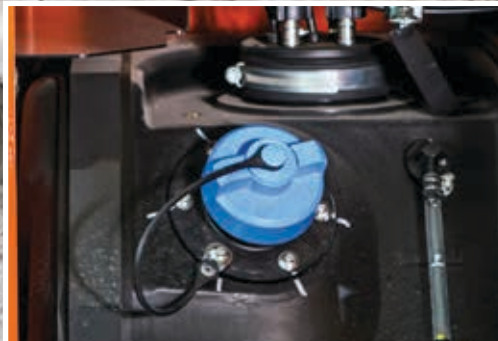
Il serbatoio dell'urea è posizionato in modo da consentire un accesso facile e sicuro dal suolo.
