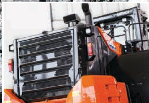
La nuova griglia posteriore protegge il vano del radiatore.
