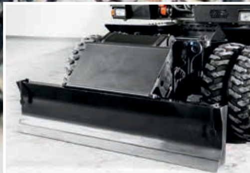
La grande copertura del cilindro della lama offre maggiore protezione.
