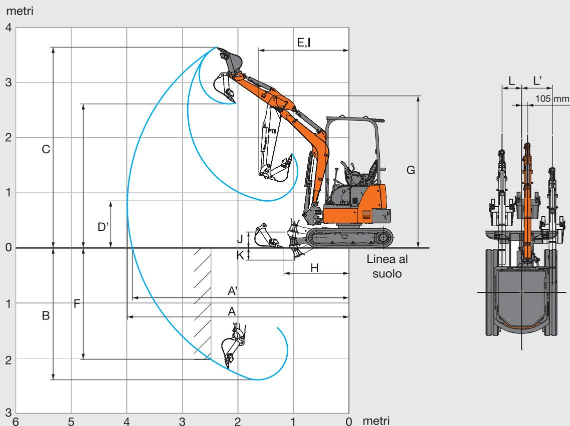
La figura mostra il modello equipaggiato con braccio di penetrazione da 1,13 m, benna da 0,044 m<sup>3</sup> e pattini di gomma da 230 mm.
