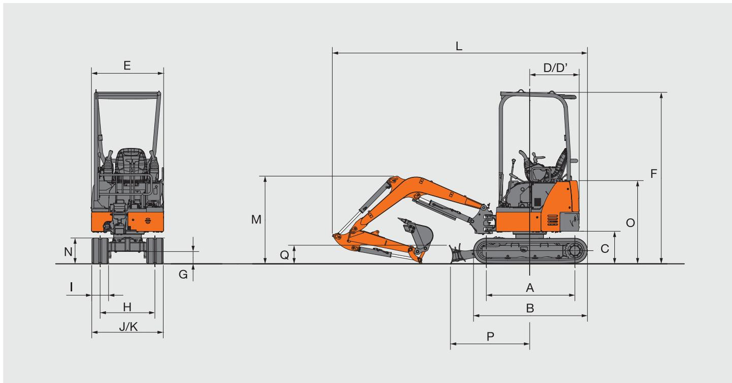
La figura mostra il modello equipaggiato con braccio di penetrazione da 0,93 m, benna da 0,044 m<sup>3</sup> e pattini di gomma da 230 mm.
