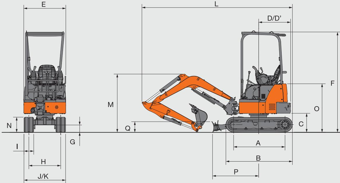
La figura mostra il modello equipaggiato con braccio di penetrazione da 1,13 m, benna da 0,044 m<sup>3</sup> e pattini di gomma da 230 mm.
