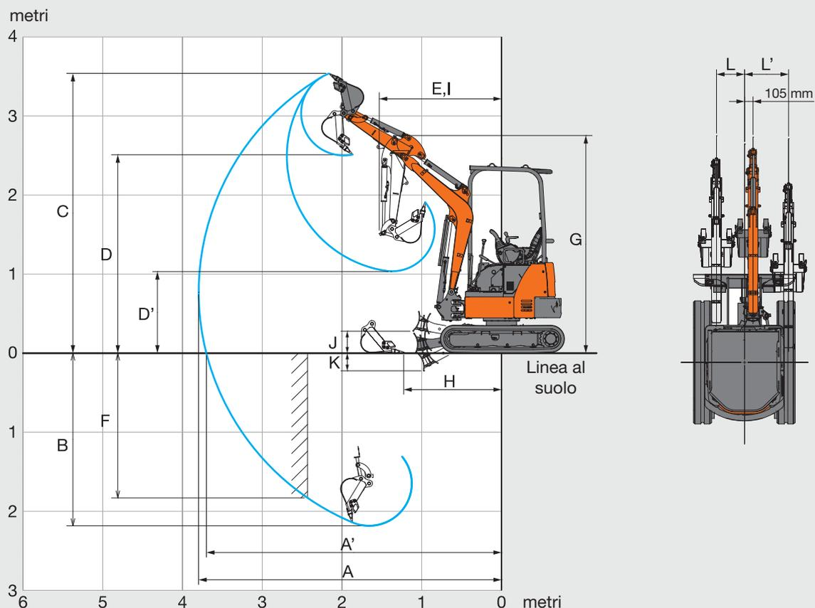
La figura mostra il modello equipaggiato con braccio di penetrazione da 0,93 m, benna da 0,044 m<sup>3</sup> e pattini di gomma da 230 mm.
