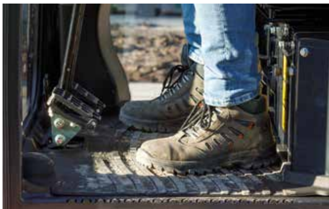
Al posto della leva manuale si possono usare i pedali di traslazione pieghevole.
