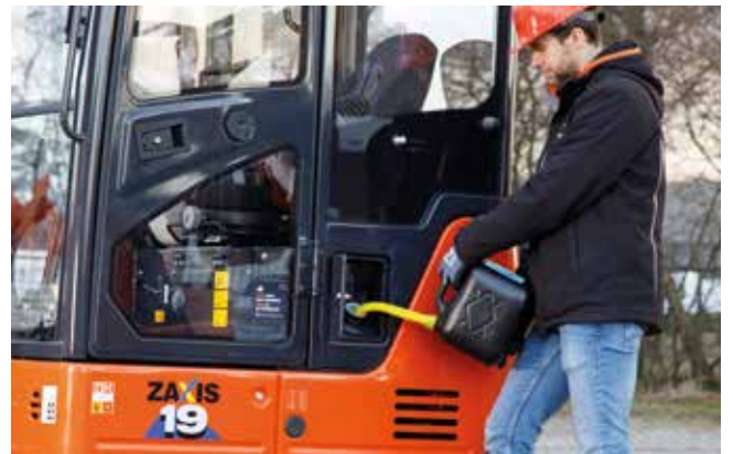
L'apertura del serbatoio del carburante è stata spostata per facilitare il rifornimento.
