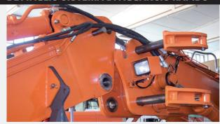
L'attacco rapido idraulico, permette un facile e veloce cambio del braccio scavo/demolizione
