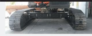
Il carro allargabile idraulicamente può variare da: 2.500 mm a 3.500 mm
