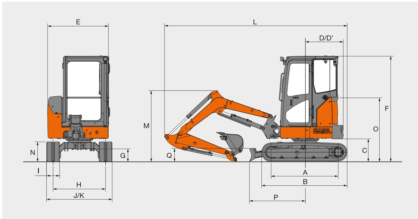
La figura mostra il modello equipaggiato con braccio di penetrazione da 1,30 m, benna da 0,080 m<sup>3</sup> e pattini di gomma da 300 mm.
