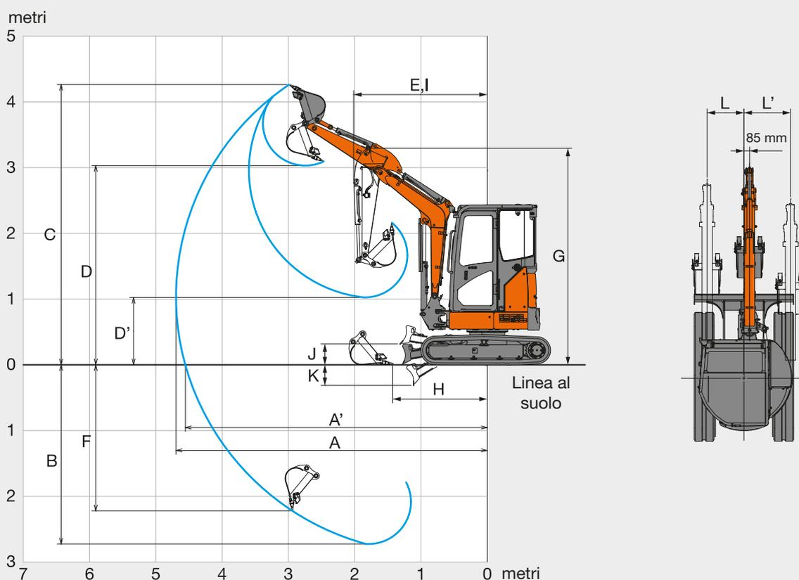
La figura mostra il modello equipaggiato con braccio di penetrazione da 1,30 m, benna da 0,080 m<sup>3</sup> e pattini di gomma da 300 mm.
