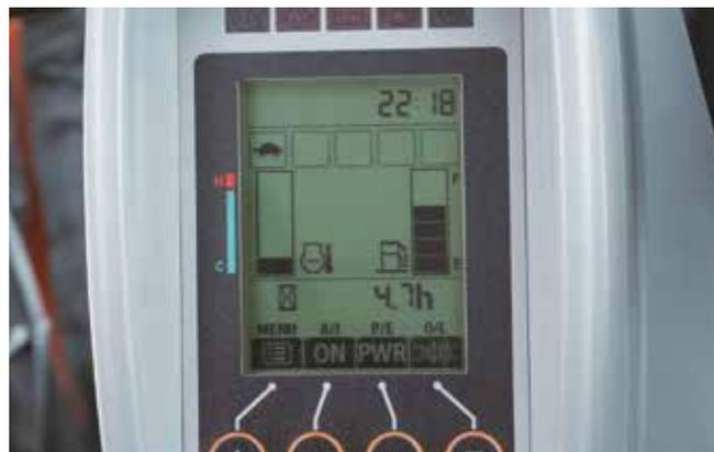
Il monitor LCD multifunzione permette di controllare i dati con una sola occhiata.
