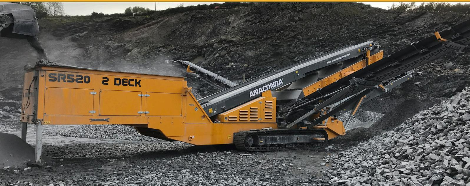
La serie di vagli di finitura mobili su cingoli Anaconda **SR** è stata sviluppata appositamente per applicazioni in cui la separazione dei materiali fini è cruciale.
