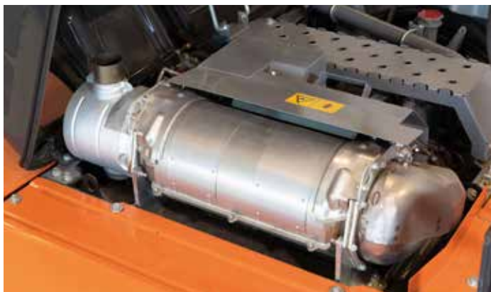
Il robusto sistema di post-trattamento evita i tempi di fermo macchina.
