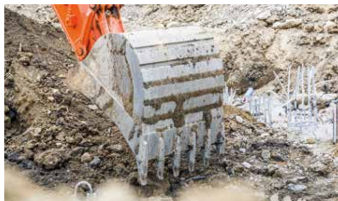
I denti GET di Hitachi comprendono denti autoaffilanti e adattatori affidabili, per garantire un montaggio preciso.
