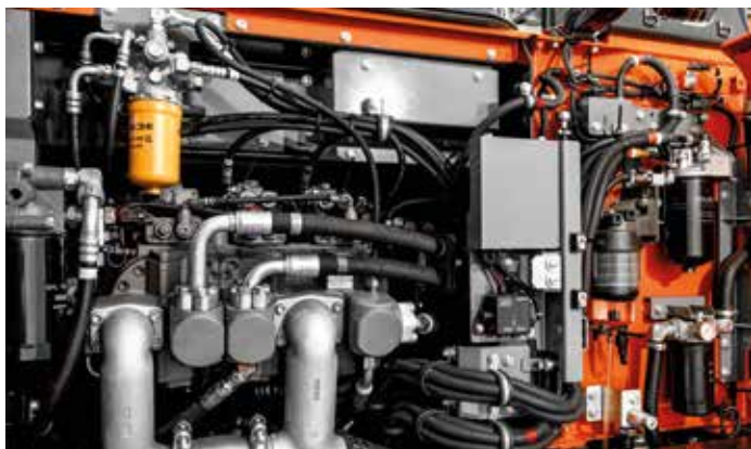
La nuova disposizione permette il facile accesso ai filtri.
