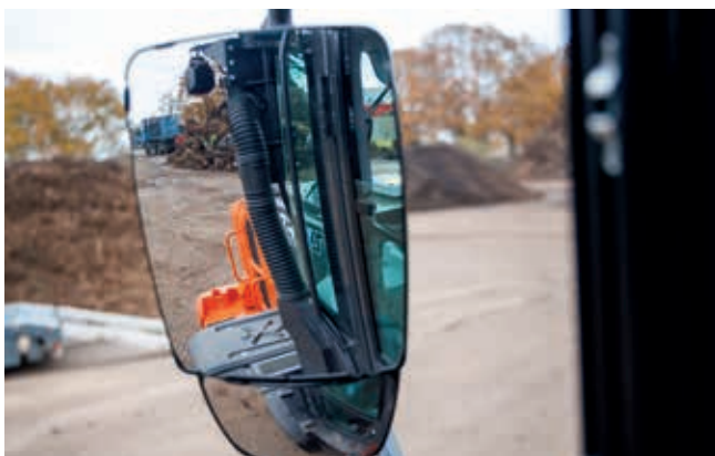
Gli specchietti regolati elettricamente forniscono una chiara vista posteriore.
