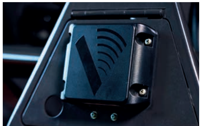
Il sistema di rilevamento degli ostacoli posteriori aumenta la sicurezza nel cantiere.
