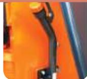
Protezione indicatore livello olio trasmissione
